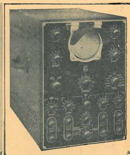
FIG. 6. - Indicatore elettrico Philips. Anno 1940 freq. max registrabile - 15'000 Hz velocità max del motore sul quale può essere usato | 9000 giri/min.
